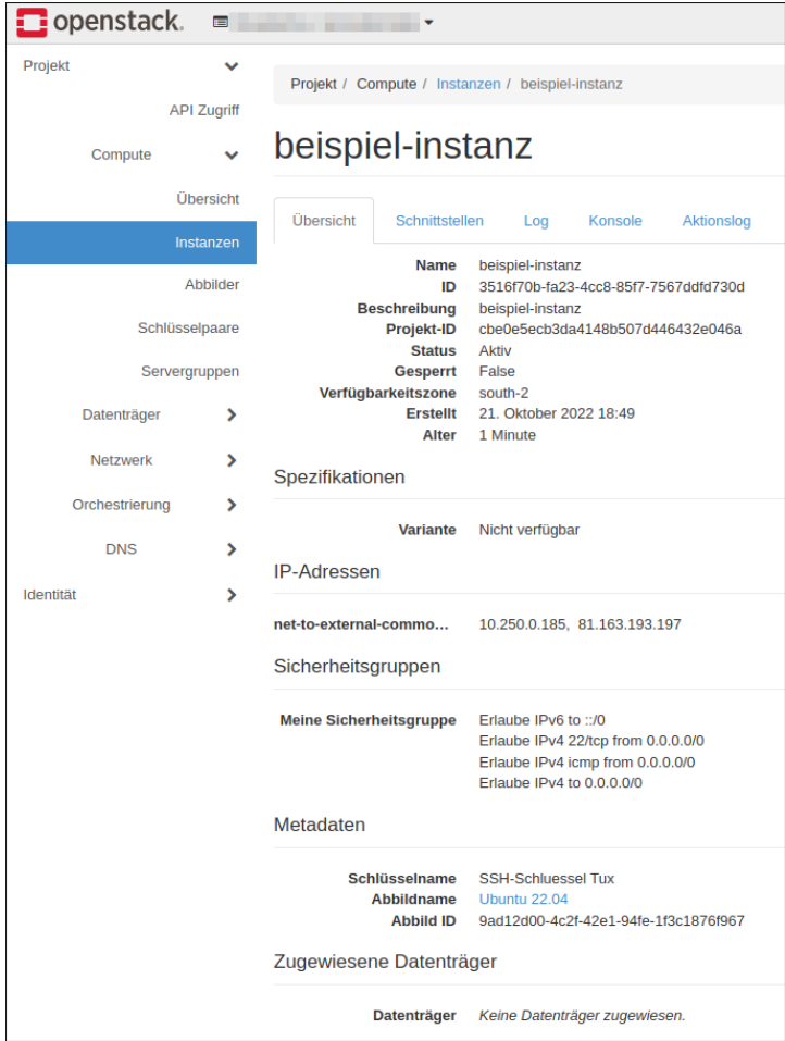
Abbildung 4.19 Spezifikationen der per Terraform erstellten Instanz in der OpenStack-Oberfläche
